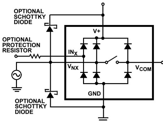
FIGURE 8. OVERVOLTAGE PROTECTION
