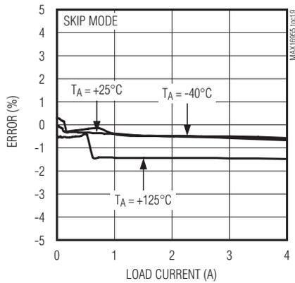
OUTPUT-VOLTAGE ERROR vs. TEMPERATURE
