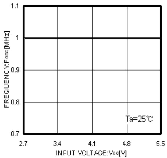
Fig.13 V<sub>cc</sub> - F<sub>osc</sub>
