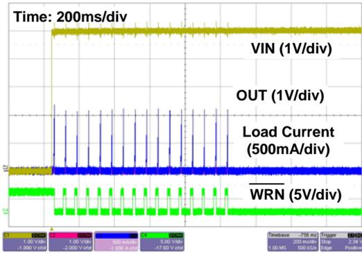
FIGURE 8. POWER-UP WAVEFORMS WHEN OUTPUT IS SHORT-CIRCUITED
