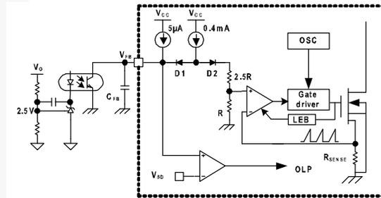
Figure 16. Pulse-Width-Modulation Circuit
