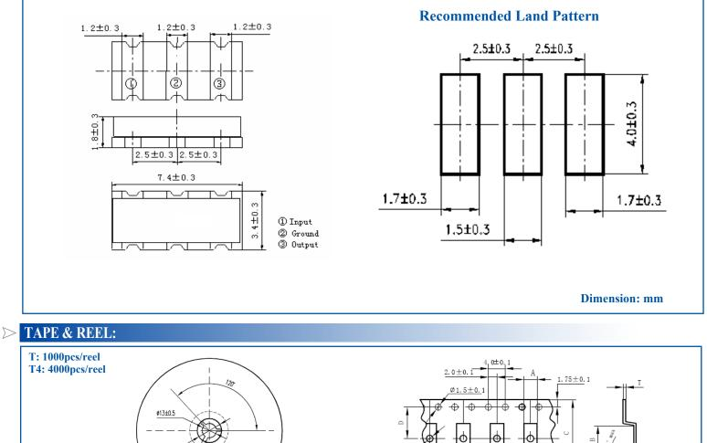
¢21±0.8 Ŕ1.0 RO. 3max 2±0.5 F D ØΝ А В С F Κ 对应产品 ØA 7.5±0,1 7.8±0.2 16.0±0.2 2.1±0.10.3±0,05 3.8±0.2 8.0±0.1 1.55±0,05 CC ØE Top Tape Peeling Strength 20-70g Carrier tape Reel Pieces per  $\overline{10}$  nax Т ΦA ΦВ W Quantity reel size 60 typ. 16.4 min ਿਹਿਯ 179±2 22.4 max 1000 (T) 1000 typ. 16  $\nabla$ 1 4000 (T4) 330±3 80 min 16.4 min 22.4 max 4000 typ 16 <u>Carrier</u> Tape
