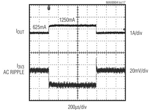
**OUTPUT VOLTAGE LOAD REGULATION (3V3)**
