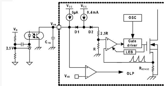
Figure 16. Pulse-Width-Modulation Circuit
