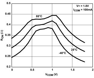
FIGURE 11. ON RESISTANCE vs SWITCH VOLTAGE
