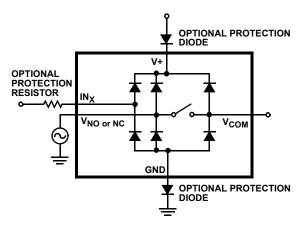
FIGURE 8. OVERVOLTAGE PROTECTION
