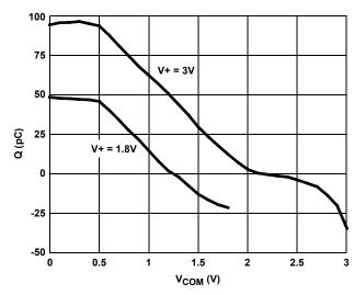
FIGURE 12. CHARGE INJECTION vs SWITCH VOLTAGE
