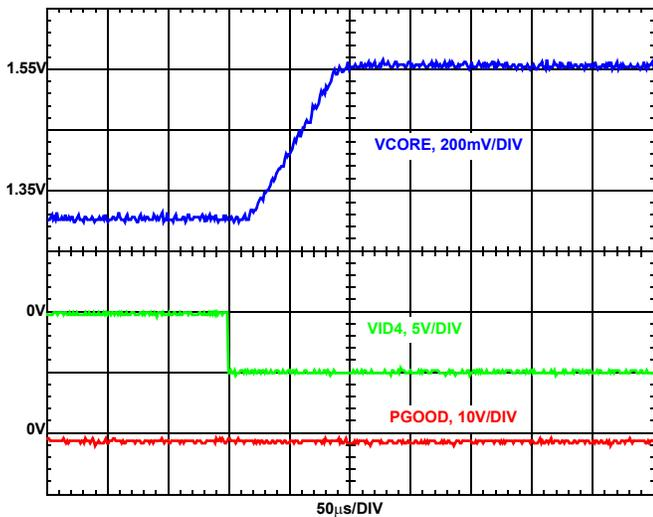
FIGURE 7. VID-ON-THE-FLY TRANSITION FROM 1.30V TO 1.55V
