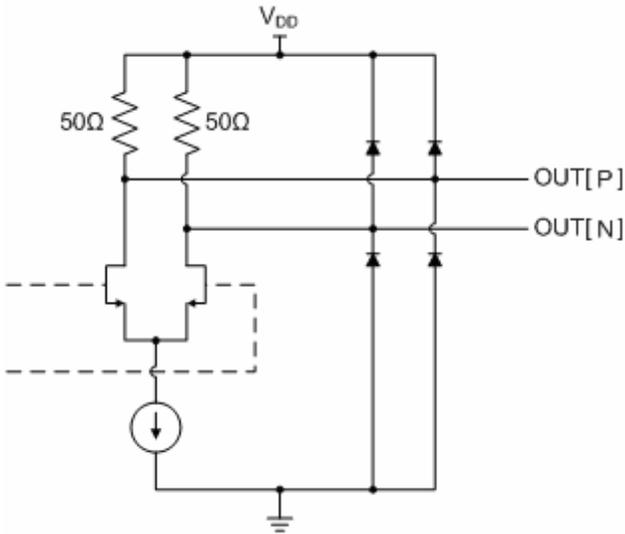
FIGURE 7. CML OUTPUT EQUIVALENT CIRCUIT FOR THE QLx111GRx
