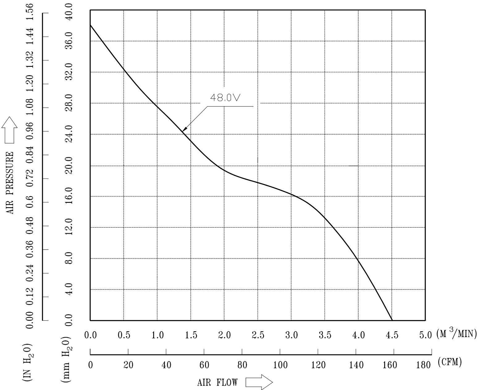
\* TEST CONDITION: INPUT VOLTAGE ——— OPERATION VOLTAGE
