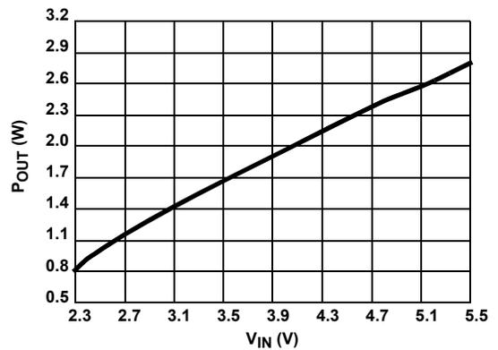
FIGURE 13. RECOMMENDED MAXIMUM OUTPUT POWER vs INPUT VOLTAGE
