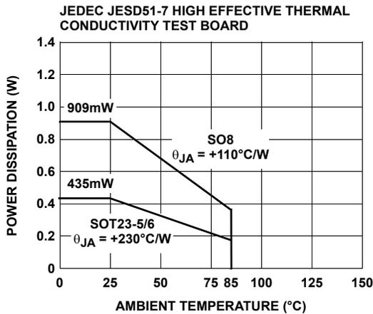
FIGURE 25. PACKAGE POWER DISSIPATION vs AMBIENT TEMPERATURE
