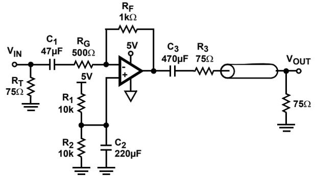
FIGURE 32. 5V SINGLE SUPPLY INVERTING VIDEO LINE DRIVER
