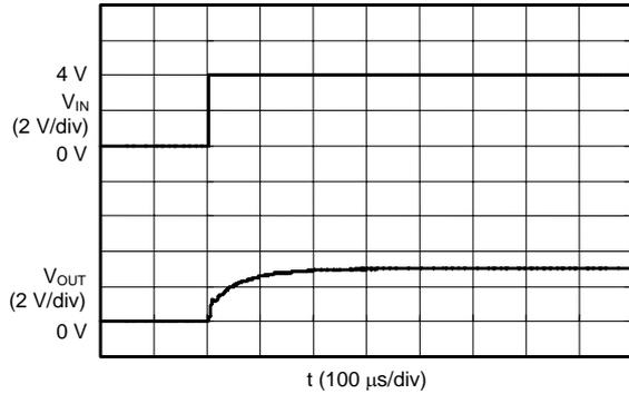
S-816A50AMC ( $V_{IN}=0\text{ V} \rightarrow 6\text{ V}$ )
