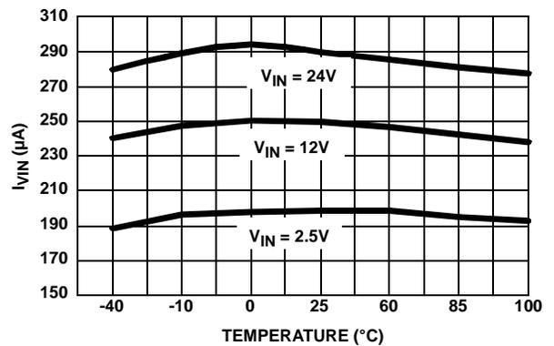
FIGURE 5. V<sub>IN</sub> CURRENT
