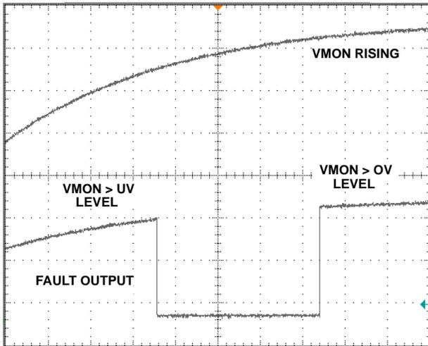
FIGURE 6. V<sub>MONITOR</sub> RISING TO FAULT
