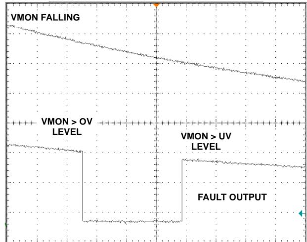
FIGURE 7. V<sub>MONITOR</sub> FALLING TO FAULT
