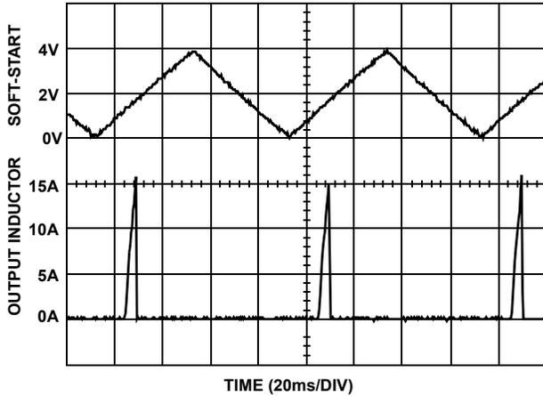
FIGURE 4. OVER-CURRENT OPERATION
