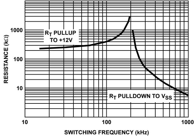
FIGURE 1. R<sub>T</sub> RESISTANCE vs FREQUENCY
