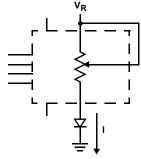
TWO-TERMINAL VARIABLE RESISTOR; **VARIABLE CURRENT**
