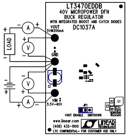
INSTALL SHUNT AT JP1 : PINS 1&2=VOUT ENABLE PINS 2&3=SHUT DOWN
