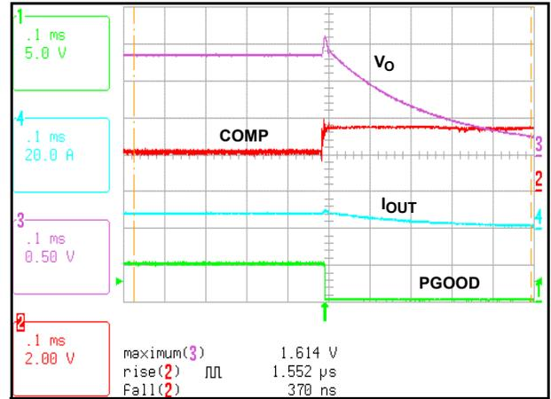
FIGURE 15. OVERVOLTAGE WAVEFORMS
