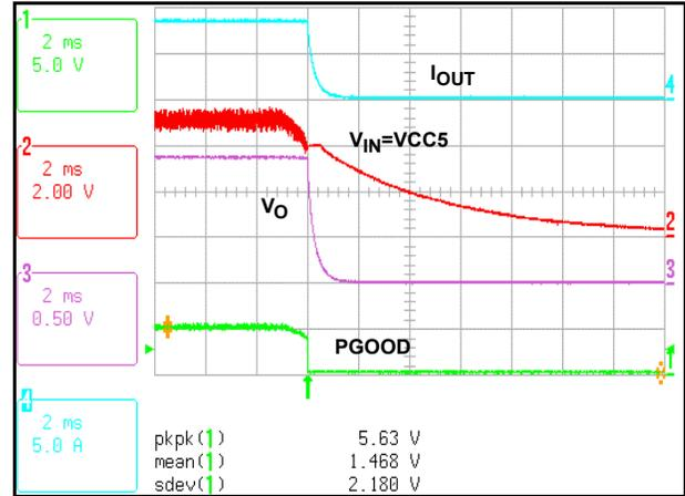
**FIGURE 6. TURN-OFF WAVEFORMS**
