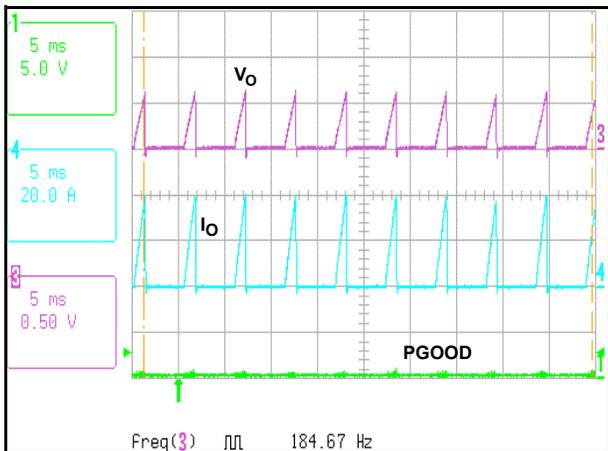
FIGURE 14. SHORT-CIRCUIT WAVEFORMS
