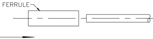
3. STRIP CABLE JACKET, BRAID, AND DIELECTRIC TO SPECIFICATION LENGTHS.
