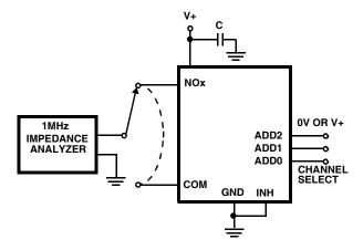
FIGURE 6. CAPACITANCE TEST CIRCUIT
