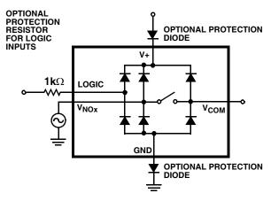
FIGURE 7. OVERVOLTAGE PROTECTION
