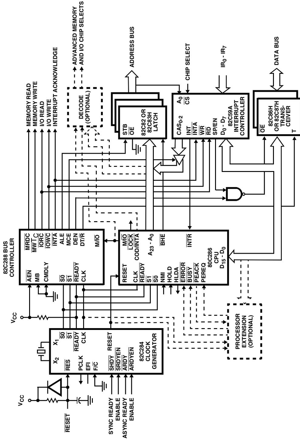
FIGURE 30. BASIC 80C286 SYSTEM CONFIGURATION
