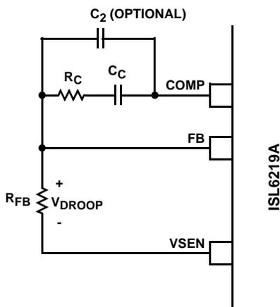
**FIGURE 11. COMPENSATION CONFIGURATION FOR LOAD-LINE REGULATED ISL6219A CIRCUIT**
