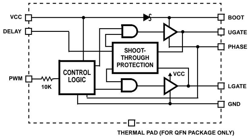
FIGURE 1. BLOCK DIAGRAM
