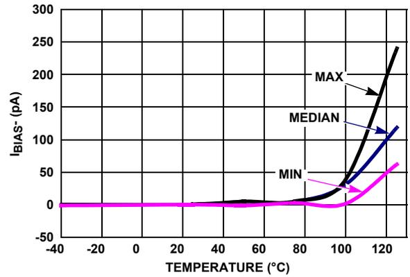
FIGURE 25.  $I_{BIAS-}$  vs TEMPERATURE  $V_+, V_- = \pm 2.5V$
