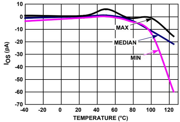
FIGURE 27.  $I_{OS}$  vs TEMPERATURE  $V_+, V_- = \pm 2.5V$
