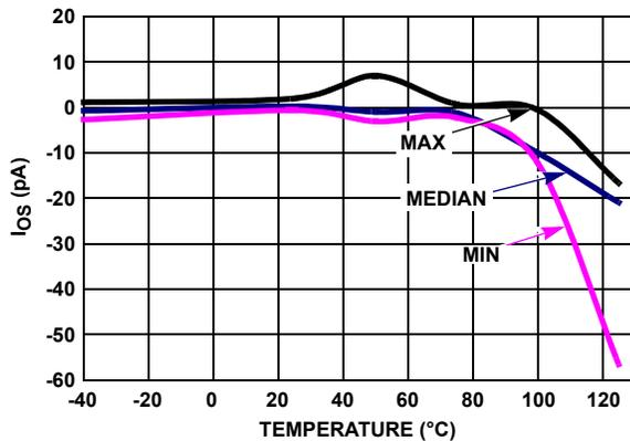
FIGURE 28.  $I_{OS}$  vs TEMPERATURE  $V_+, V_- = \pm 1.2V$
