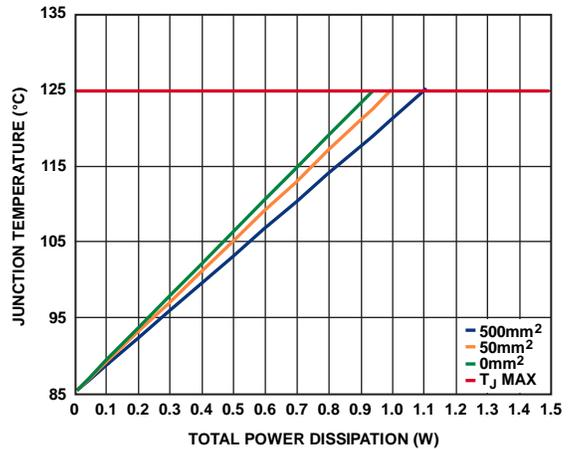
Figure 29.  $T_A = 85^\circ\text{C}$ , LFCSP
