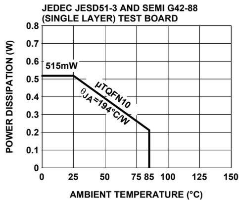
FIGURE 21. PACKAGE POWER DISSIPATION vs AMBIENT TEMPERATURE
