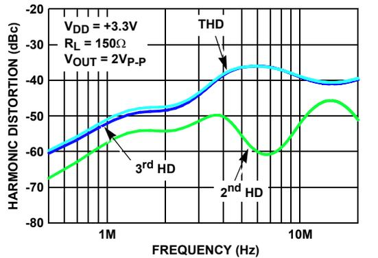
FIGURE 15. HARMONIC DISTORTION vs FREQUENCY
