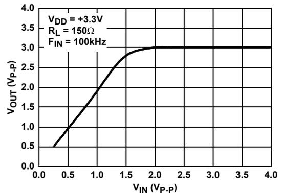
FIGURE 4. MAXIMUM OUTPUT MAGNITUDE vs INPUT MAGNITUDE
