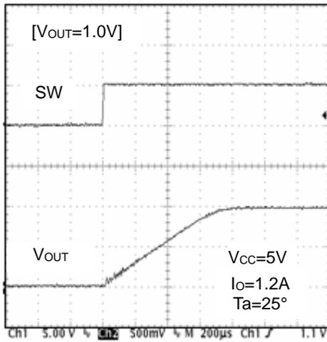
Figure 14. Soft-Start Waveform
