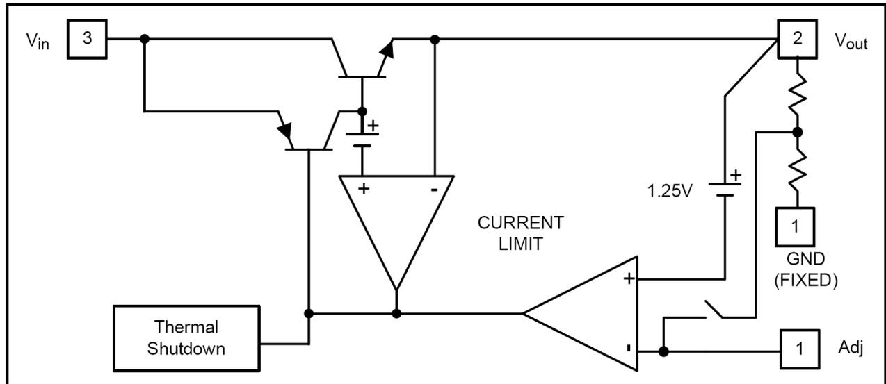
**Figure 3. Block Diagram**
