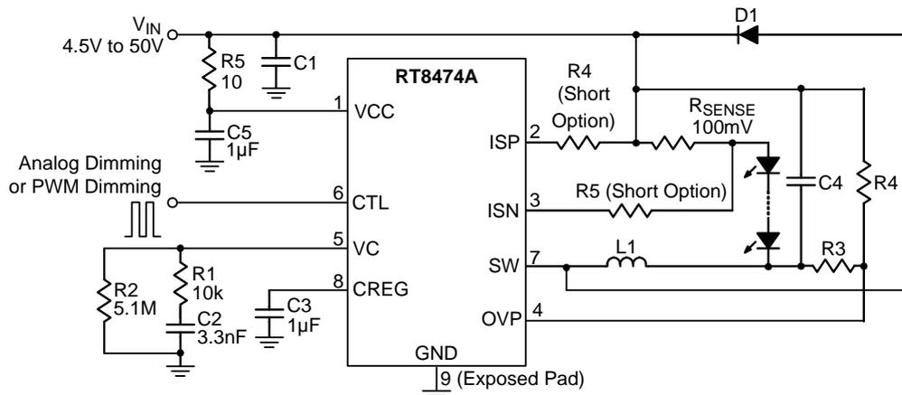
Note :  $V_{IN}, V_{SW}, V_{ISP}, V_{ISN} < 50V$
