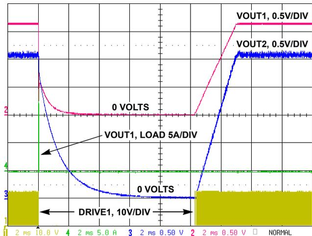
FIGURE 6. UNDERVOLTAGE PROTECTION
