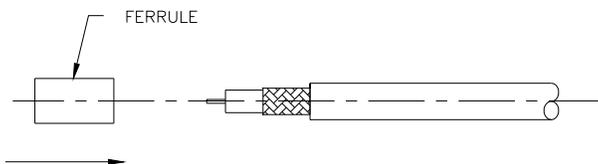
3. STRIP CABLE JACKET, BRAID AND DIELECTRIC TO SPECIFICATION LENGTHS.
