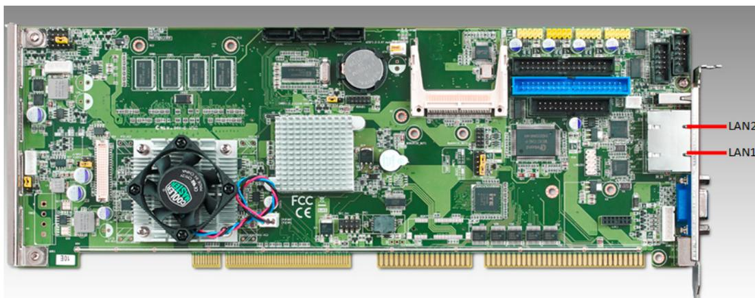
Figure 2.11 LAN RJ45 connector (LAN1/LAN2)
