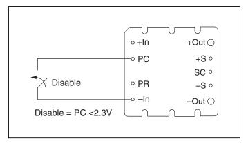
Figure 2 — Module enable/disable.
