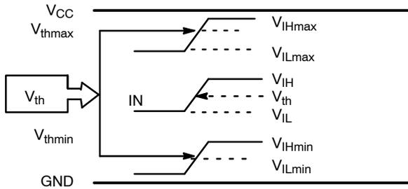
Figure 8.  $V_{th}$  Diagram
