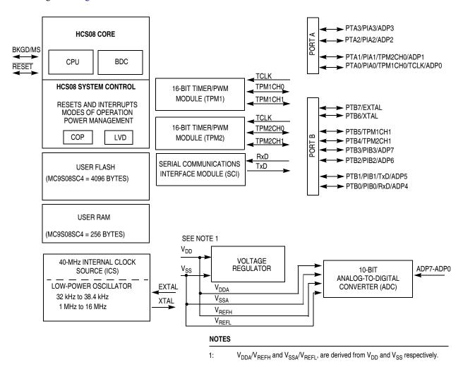
Figure 1-1. MC9S08SC4 Block Diagram
