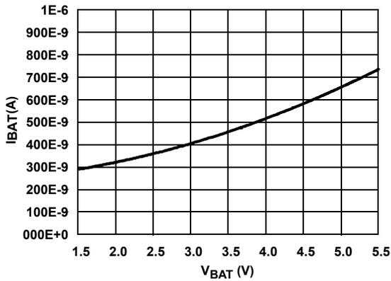
FIGURE 1. I<sub>BAT</sub> vs V<sub>BAT</sub>
