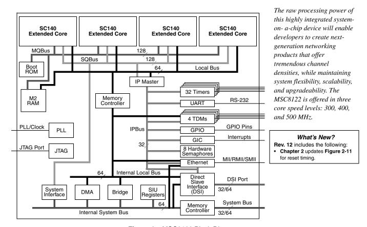
Figure 1. MSC8122 Block Diagram
