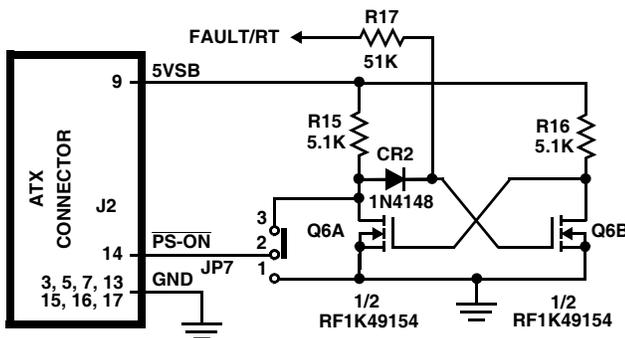
**FIGURE 3. ATX POWER SUPPLY CONTROL CIRCUIT**
