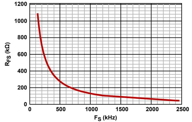
FIGURE 16. R<sub>FS</sub> vs FREQUENCY
