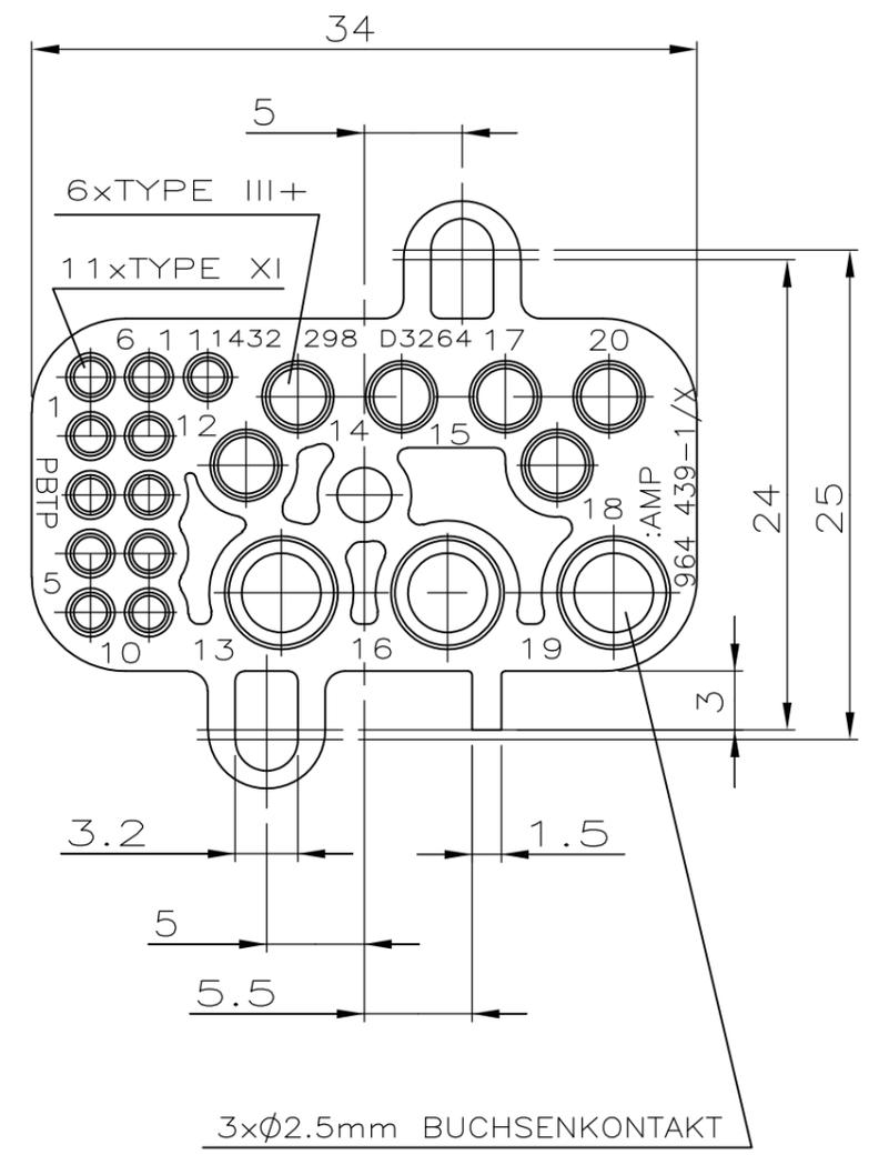
MINIMALE KONTAKTUEBERDECKUNG BEI TYPE XI-KONTAKTEN 0.8mm
