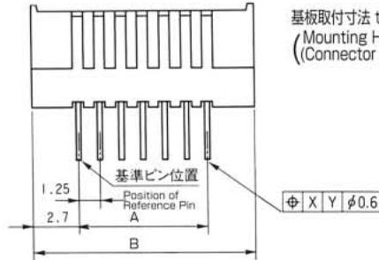
基板取付寸法  $t=0.8\sim 1.6\text{mm}$ (コネクター搭載面)
