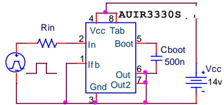
Figure 2 : Iboot test circuit
