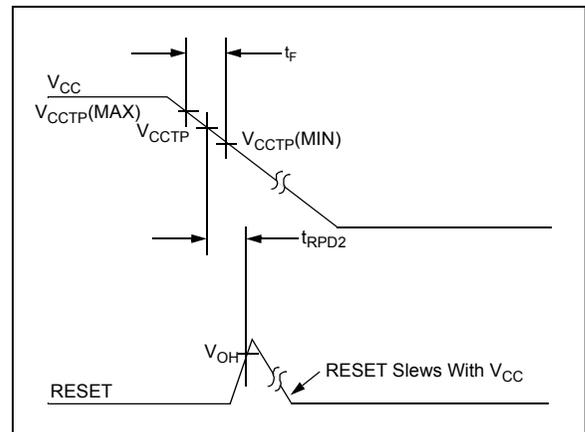
**FIGURE 4-4:** Timing Diagram – Power Down (TC1274).
