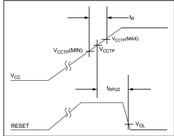
**FIGURE 4-3:** Timing Diagram – Power Up (TC1274).
