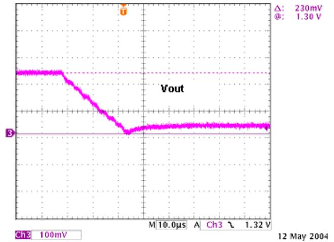
FIGURE 6. VID-ON-THE-FLY TRANSITION FROM 1.55V TO 1.30V
