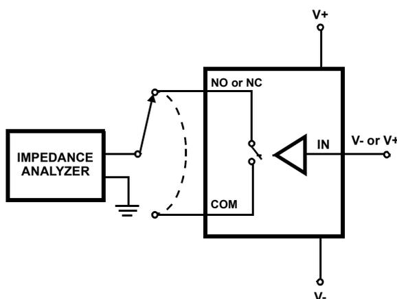
FIGURE 5. CAPACITANCE TEST CIRCUIT
