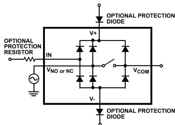
FIGURE 6. OVERVOLTAGE PROTECTION
