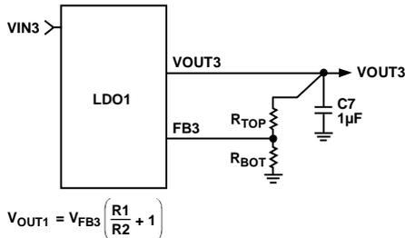
$$V_{OUT1} = V_{FB3} \left( \frac{R1}{R2} + 1 \right)$$
