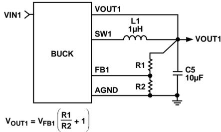
$$V_{OUT1} = V_{FB1} \left( \frac{R1}{R2} + 1 \right)$$
