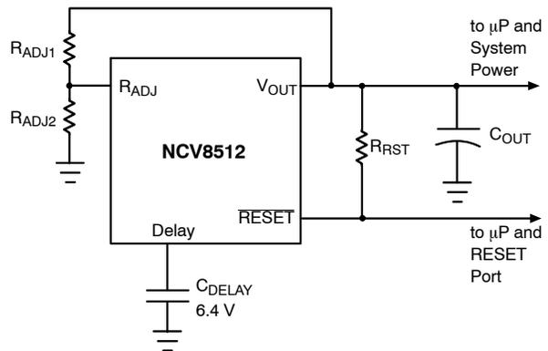
Figure 12. Adjustable  $\overline{\text{RESET}}$
