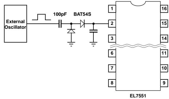
FIGURE 1. OSCILLATOR SYNCHRONIZATION
